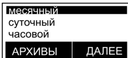
**Рис. 8 – Экран ЖКИ в режиме «Архивы»**
