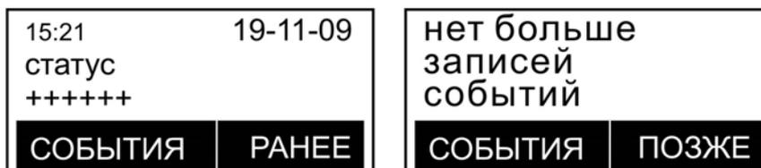
**Рис. 10 – Экран ЖКИ в режиме «События»**
