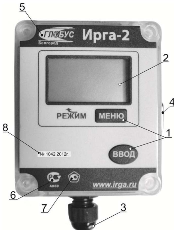
Рис. 1 – Внешний вид вычислителя
