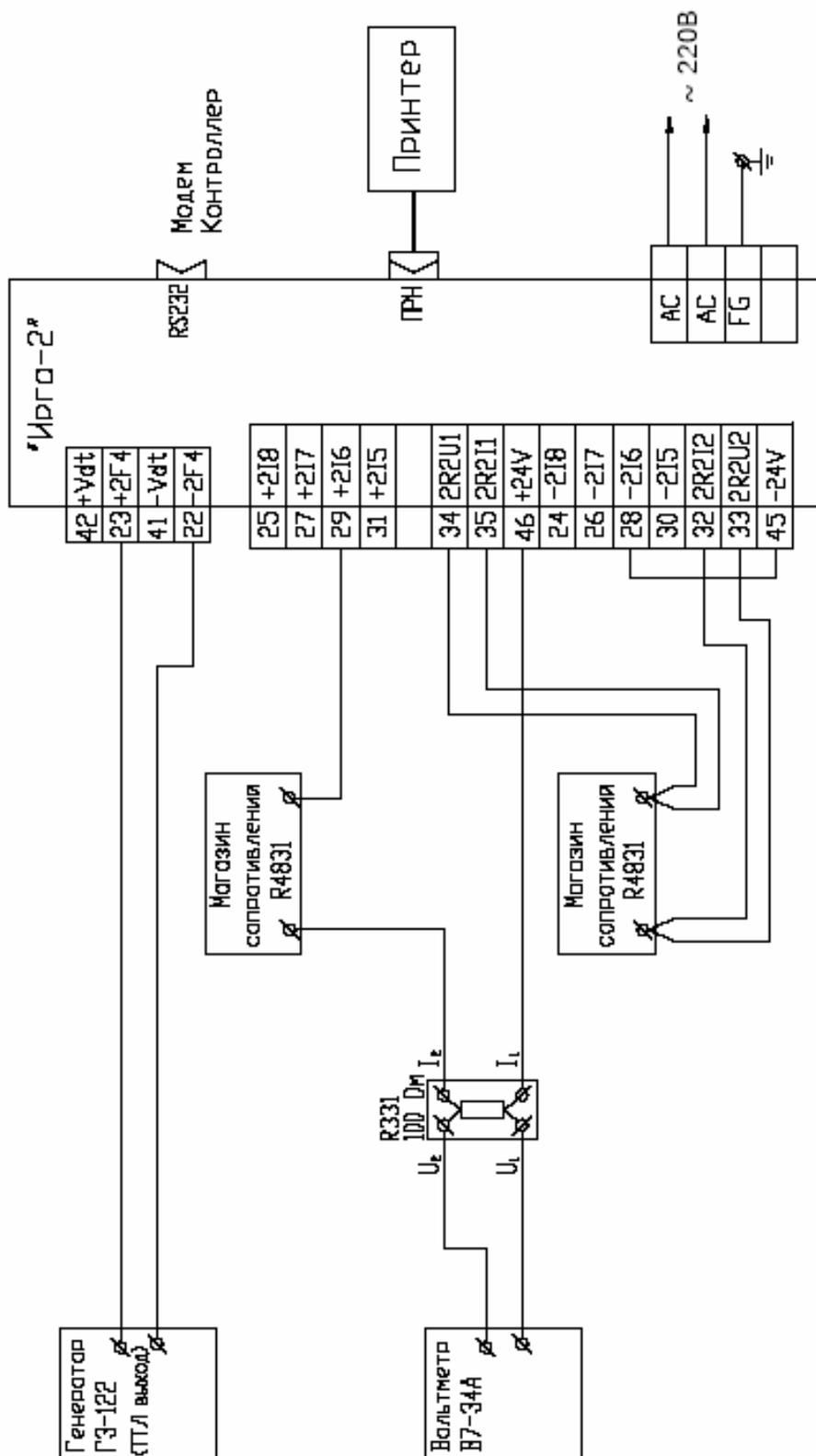
В.3 С расходомером на СУ (два дифманометра). Канал 1
