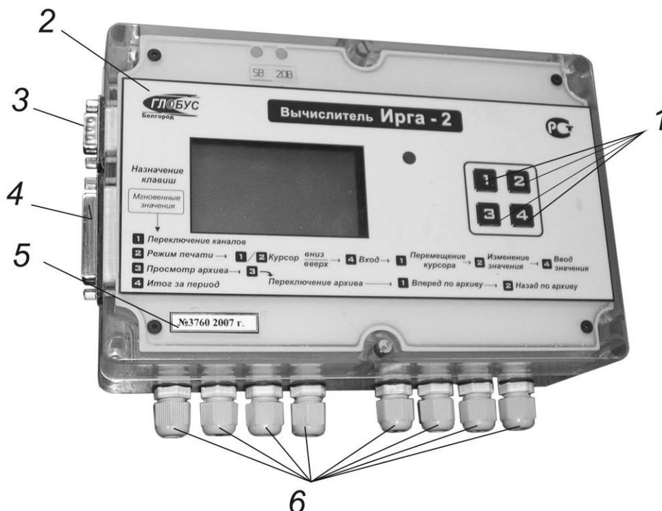
1 – клавиатура; 2 – логотип предприятия; 3 – разъем RS-232 для подключения к внешним устройствам; 4 – разъем «Принтер»; 5 – заводской номер вычислителя и год выпуска; 6 – кабельные входы для подключения ПП и питания.
