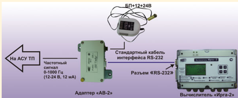
Рис. 2. Схема с использованием дискретного сигнала. В схеме используется адаптер «АВ-2», подключаемый к вычислителю стандартным кабелем интерфейса RS-232. Выходной частотный сигнал представляет собой импульсы с частотой 0-1000 Гц, с амплитудой от 12 до 24 В. Частота следования импульсов пропорциональна мгновенному расходу измеряемой среды, унифицированный диапазон частот (0-1000 Гц) может быть изменен при заказе адаптера.
